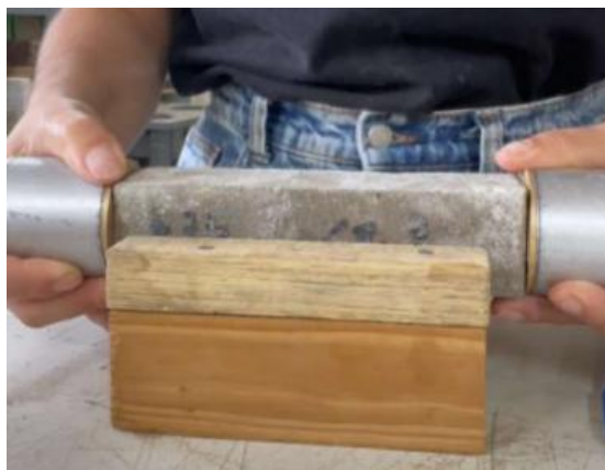
Figura 08: Ensaio de módulo de elasticidade dinâmico das argamassas estudadas
