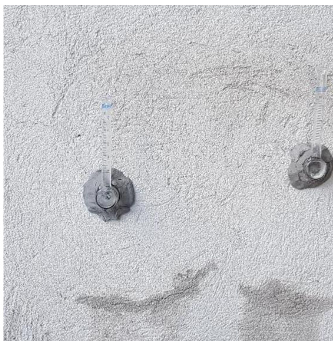
Figura 15: Ensaio de Permeabilidade pelo método de cachimbo nos Painéis de Alvenaria já revestidos
