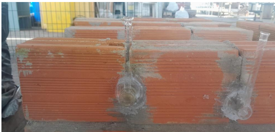
Figura 14: Ensaio de Permeabilidade pelo método de cachimbo nas Alvenarias
