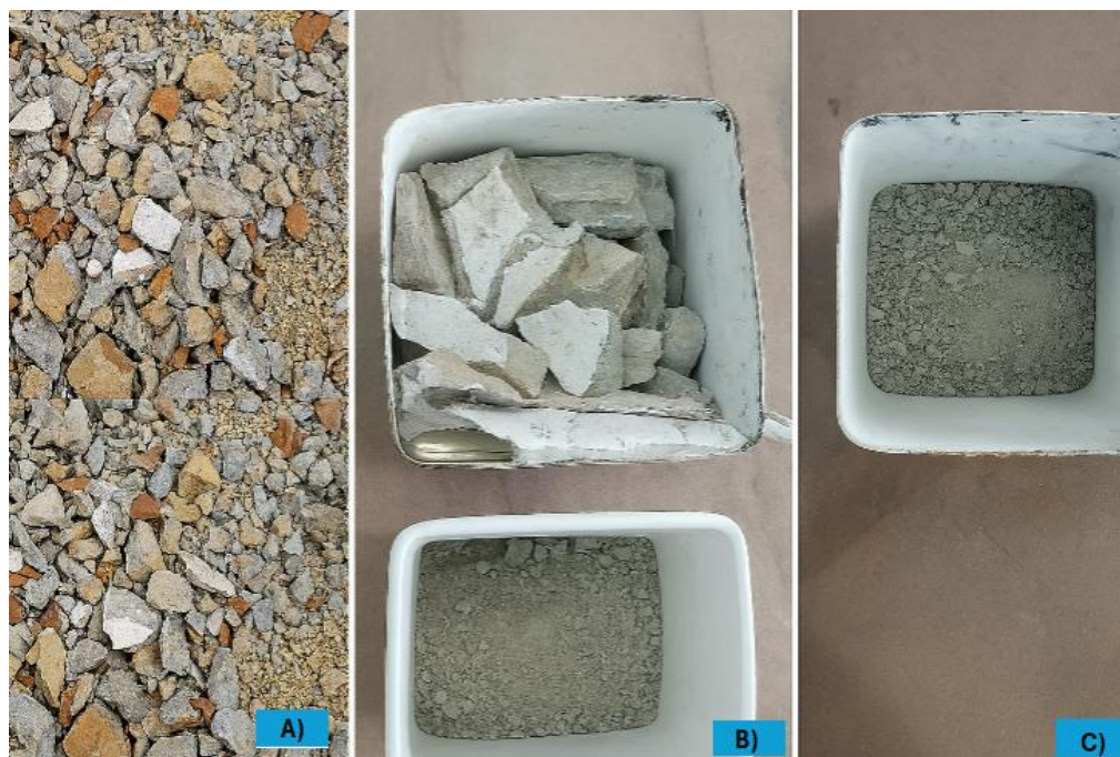
Figura 03: Identificação do Resíduo Reciclado Utilizado – (a) Resíduo em obra, (b) Resíduo coletado que será beneficiado, (c) Resíduo beneficiado
