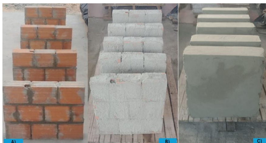
Figura 11: Mini Painéis Executados para as possíveis análises – (a) Painéis de Alvenaria com Tijolos Cerâmicos Executados, (b) Aplicação da Camada de Chapisco nas superfícies dos Painéis de Alvenaria, (c) Aplicação da Camada de Reboco nas superfícies dos Painéis de Alvenaria
