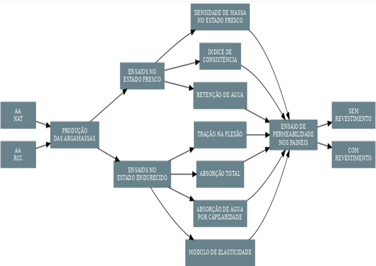
Figura 04: Fluxograma do Planejamento Experimental
