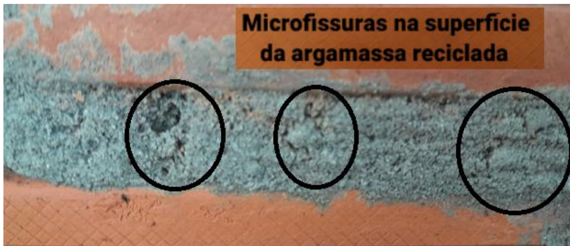
Figura 19: Aparecimento de Microfissuras nas juntas nos painéis de alvenaria executados
